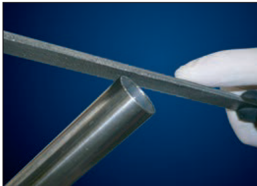
3 Desbarbar el tubo interior y exteriormente.
