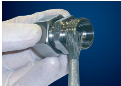
4 Engrasar con Inxopaste el cono interior de 24° y la rosca exterior.
